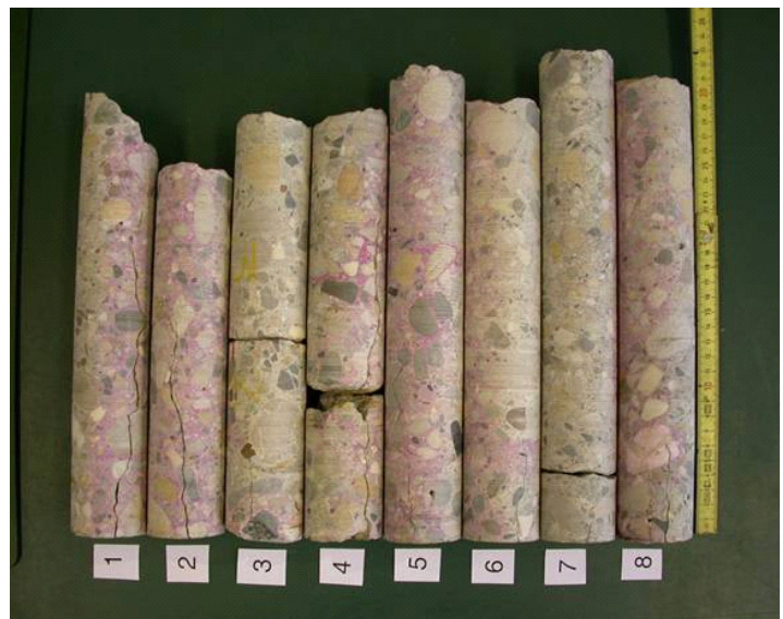
Abbildung 6-59: Bohrkern aus einem Bauwerk mit Schalenrisse in diversen Tiefen und senkrecht ab Oberfläche verlaufenden Rissen
