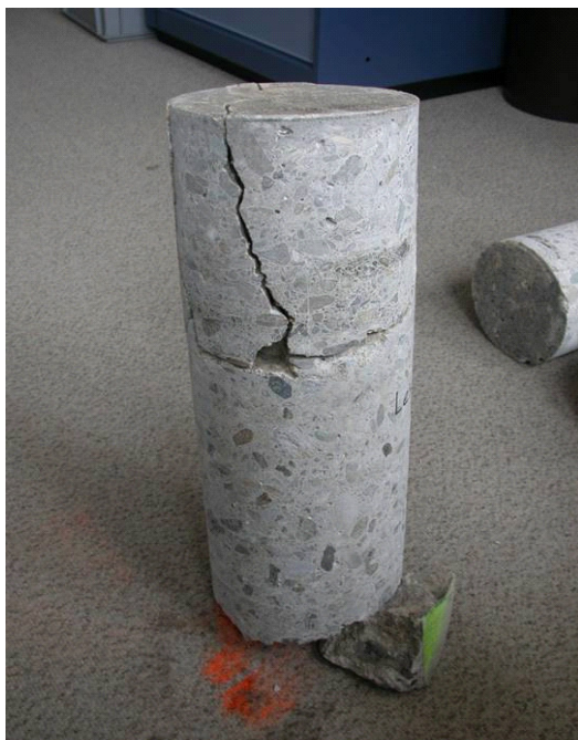
Abbildung 6-59: Bohrkern aus einem Bauwerk mit Schalenrisse in diversen Tiefen und senkrecht ab Oberfläche verlaufenden Rissen
